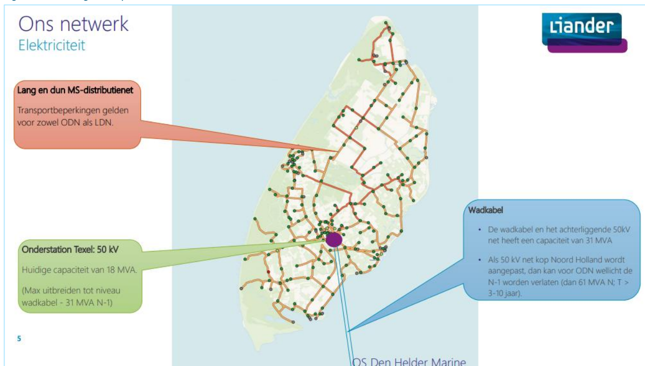
Figuur 6. Het netwerk op Texel. LDN = levering door netbeheerder (aan eindgebruiker). ODN = opname door netbeheerder (van opwek). Bron: Liander.
